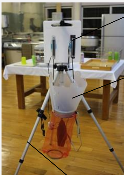
飛来した昆虫を吸い込むファン
