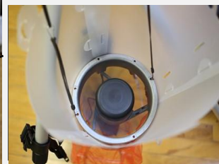
飛来した昆虫を吸い込むファン
